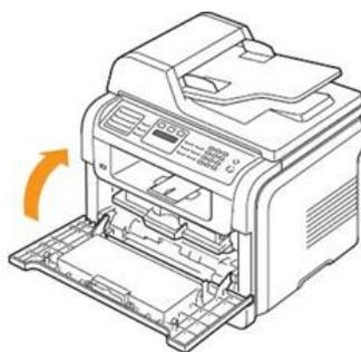
La cubierta frontal de la fotocopidora es una especie de tapa que protege su interior. Si está cubierta está abierta la fotocopidora no funciona.
